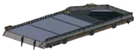
вариант стола "сетка" для мелкосеменных культур
