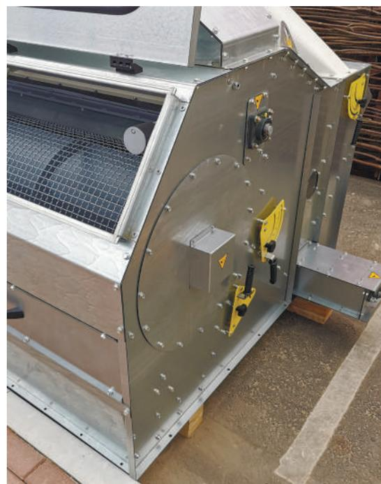
Сепаратор СВБ предназначен для предварительной очистки зернового вороха от мелких примесей, песка, пыли и других легких инородных тел, соломы и крупных посторонних элементов при приемке зерна на мехтоках, КЗСах и элеваторных комплексах.
