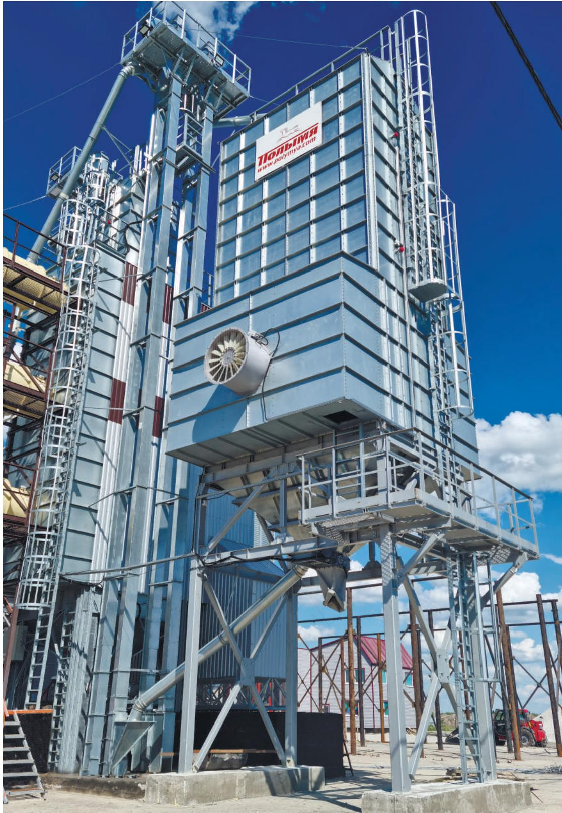
Бункер зерновой охлаждения БЗ0-80 предназначен для охлаждения зерновой массы после сушки до температуры окружающей среды. Поток воздуха оказывает воздействие на температуру и влажность зерна, от которых напрямую зависит его сохранность, а также предупреждает развитие насекомых-вредителей и плесневых грибов.
