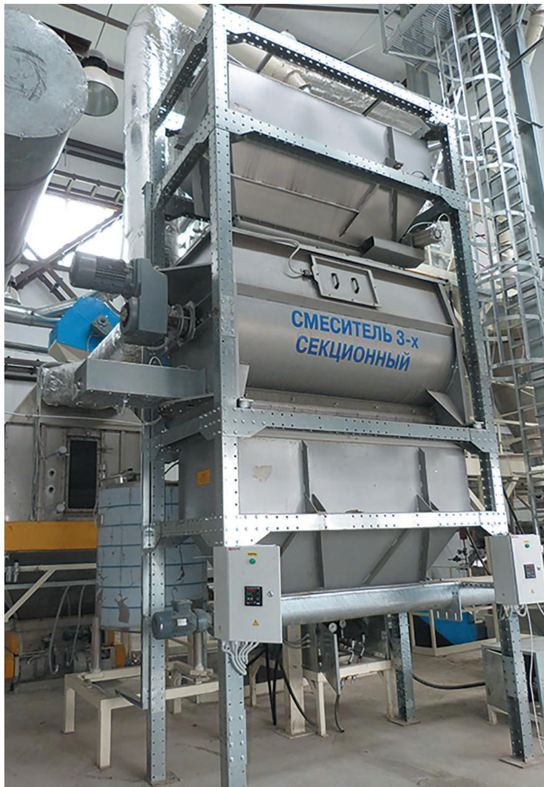
Смеситель предназначен для смешивания кормов и БМВД. В основе принципа работы смесителя положен процесс взаимопроникновения двух слоев, образуемых двумя спиралями вала смесителя. Наружная спираль в виде квадрата перемещает материал на мотор-редуктор, а внутренняя спираль из листового металла – от мотор-редуктора, перемешивая компоненты комбикорма.
