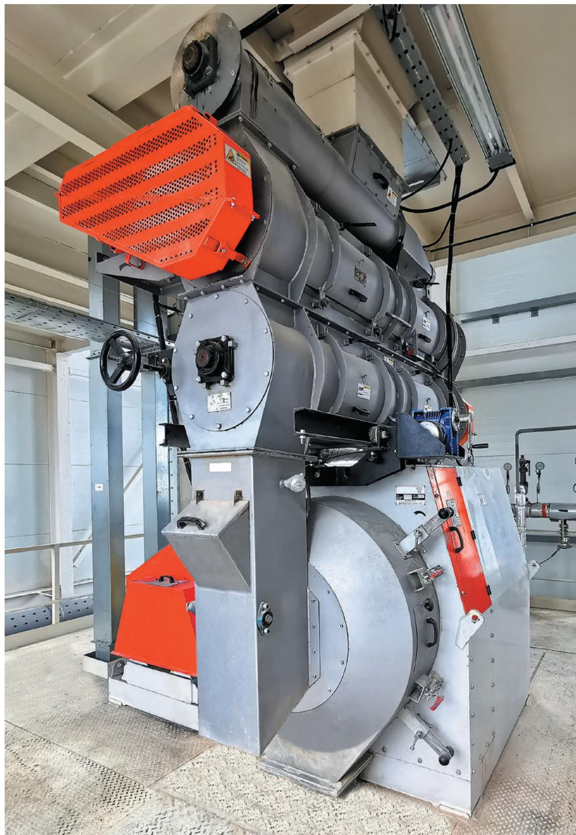
Гранулированию, как правило, предшествует гидротермическая обработка рассыпного комбикорма, т.е. увлажнение и нагревание смеси в кондиционерах-смесителях. Под воздействием пара благодаря подводу тепла и влаги комбикорм подвергается структурномеханическим и биохимическим изменениям. В стандартной комплектации пресс-гранулятор РТМ комплектуется шнековым питателем и двойным кондиционером-смесителем.
