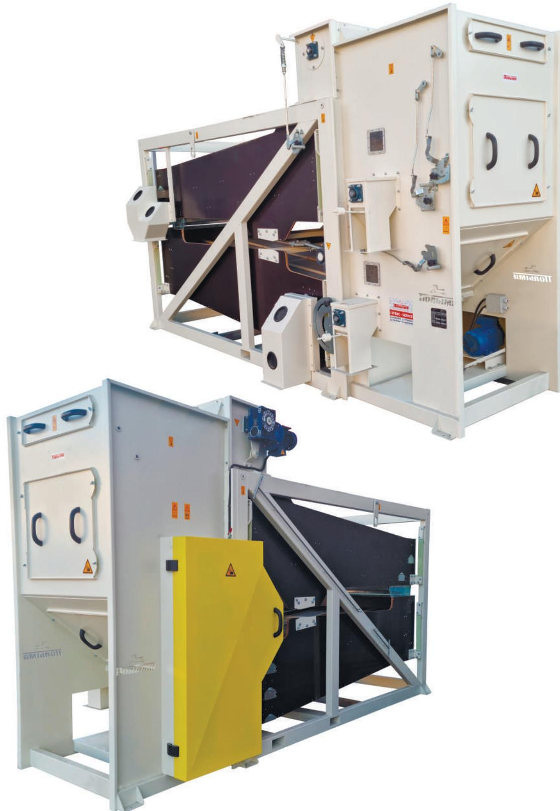
Машины серии TOP предназначены для тонкой очистки и (или) сортировки различных видов культур, обязательно прошедших первичную и вторичную очистку на воздушно-решетных сепараторах. TOP используется в составе линий и комплексов по подготовке семенного материала, а также подготовки зерна к переработке на мукомольных и крупяных предприятиях.
