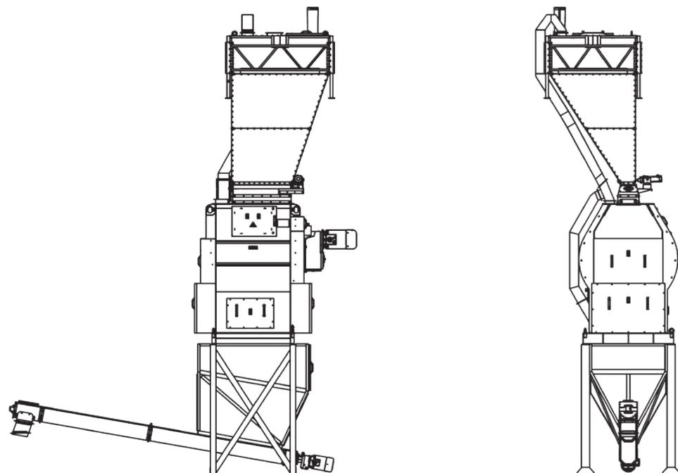
Смеситель СГП. Лопастной смеситель периодического действия, предназначен для смешивания обогатительных смесей, компонентов комбикормов, премиксов в однородную кормовую смесь для животных, птицы и рыбы. Во время смешивания в смеситель могут быть добавлены различные виды жидких добавок в количестве до 5% (не более трех жидкостей). Конструкция смесителя отличается надежностью и долговечностью в эксплуатации.
